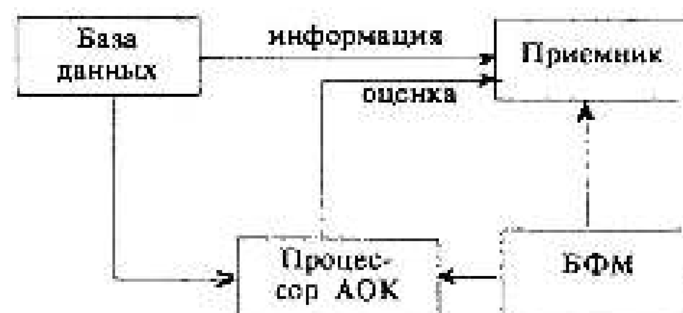
Р и с. 4. Блок-схема оценки качества информации на ЭВМ
