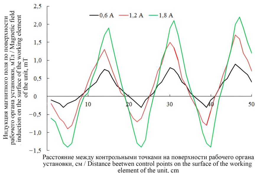
Р и с. 3. Распределение магнитной индукции на поверхности рабочего органа установки для обработки семян льна-долгунца в градиентном магнитном поле
