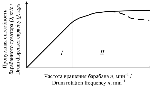
Р и с. 1. Зависимость пропускной способности барабанного дозатора-метателя от частоты его вращения: I – участок линейной связи; II – участок не линейной связи
