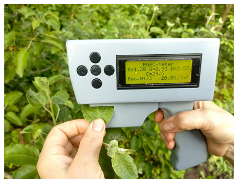
Р и с. 4. Использование листового фотоколориметра для прогнозирования CC в листьях
