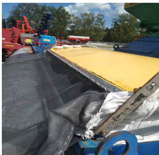
Р и с. 3. Кронштейн для крепления и регулировки положения верхней крышки F i g. 3. Bracket for fixing and adjusting the position of the top cover
