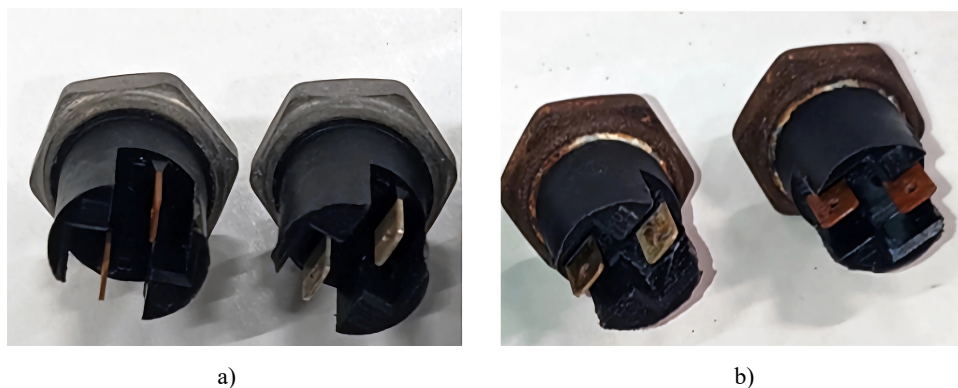
Р и с. 1. Общий вид выключателей заднего хода зерноуборочного комбайна С-исполнения с медными клеммами: а) до; б) после воздействия соевым туманом
