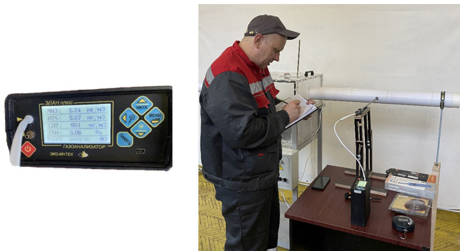
Р и с. 4. Измерение концентрации газов с помощью пробоотборного зонда и газоанализатора ЭЛАН плюс
