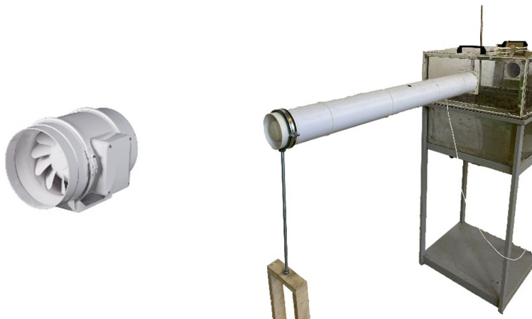
Р и с. 3. Приточный воздуховод и вмонтированный в него регулируемый вентилятор
