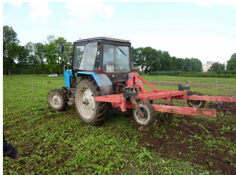
Р и с. 2. Глубокое рыхление почвы агрегатом МТЗ-82.1+УКПА 2.4-2
