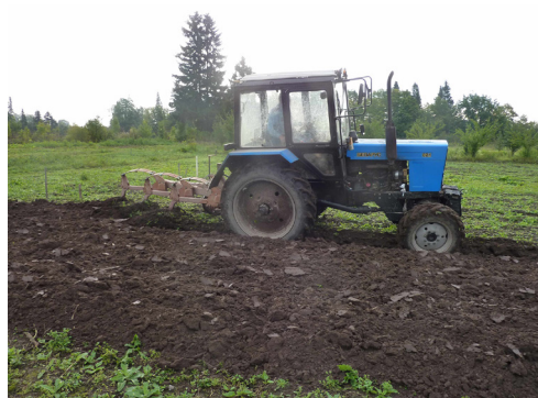
Р и с. 1. Вспашка почвы агрегатом МТЗ-82.1+ПКМП-3-40Р
