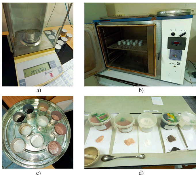
Р и с. 1. Определение влажности гранулированных минеральных удобрений:
