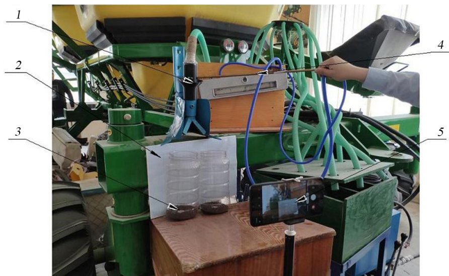
Р и с. 6. Измерение скорости воздушного потока и удобрений в зонах II и III: 1 – сошник; 2 – миллиметровая бумага; 3 – емкость с удобрениями; 4 – трубка Пито-Прандтля; 5 – камера для замедленной фото- и видеофиксации
