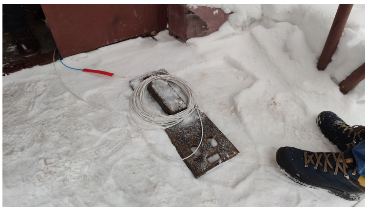
Р и с. 5. Начало испытания экспериментальной модели системы прямого индукционного нагрева металлических изделий, работающей в резонансном режиме на повышенной частоте
