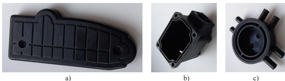
Р и с. 5. Прототипы, изготовленные на 3D-принтере: а) крышка гидрораспределителя; б) корпус электронного блока; в) корпус вакуумного дозатора доильной установки
