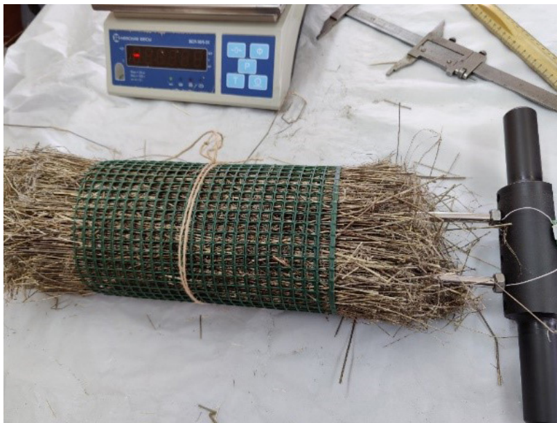
Р и с. 7. Измерение влажности стеблей F i g. 7. Measuring the moisture content of stems
