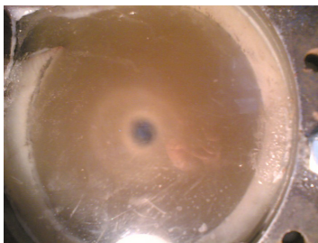
Р и с. 10. Визуализация области отрыва потока через оптически прозрачную глухую торцевую стенку вихревой камеры
