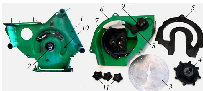
Р и с. 1. Исследуемый вакуумный высевающий аппарат F i g. 1. Vacuum seed-placing unit under study
