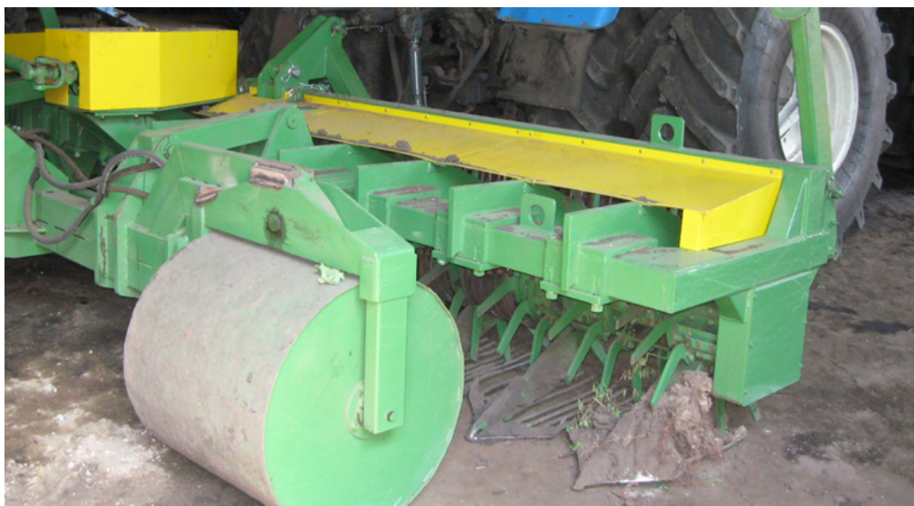
Р и с. 6. Машина почвообрабатывающая рыхлительно-сепарирующая ПРСМ-5 с рыхлителями ротора обоснованной формы
