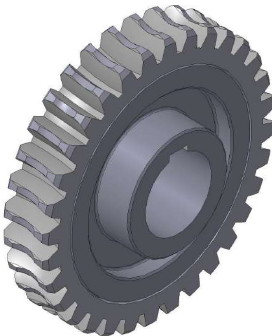
Р и с. 9. Модель червячного колеса в сборе F i g. 9. Model of assembled worm gear
