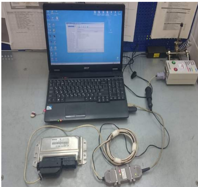
Р и с. 1. Программирование ЭБУ в режиме «BootstrapLoader» (BSL) F i g. 1. ECU Programming mode BootstrapLoader (BSL)
