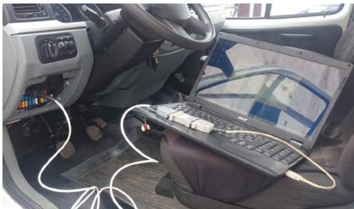
Р и с. 2. Программирование ЭБУ через разъем диагностики «EOBD II» F i g. 2. Programming the ECU via diagnostic connector EOBD II
