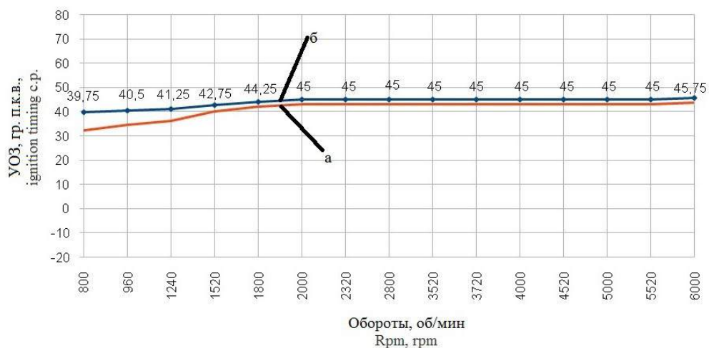
Р и с. 5. Оптимальный угол опережения зажигания (а – УОЗ для базового ПО; б – УОЗ для модифицированного ПО)
