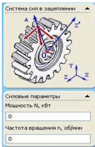
Рис. 3. Фрагмент панели для задания динамических и кинематических параметров передачи
