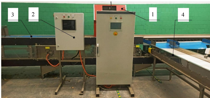
Р и с. 10. Система технического зрения линии сортировки ЛСП-4: 1 – оптический модуль с видеокамерой и структурной подсветкой; 2 – электронный блок управления; 3 – конвейер; 4 – выходной транспортер для отсортированных плодов
