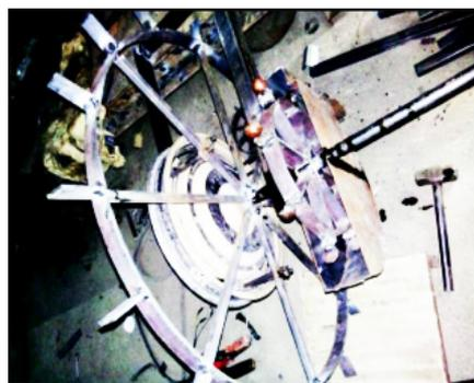
Р и с. 4. Дисковый высевальный аппарат с диаметрально расположенными лопатками
