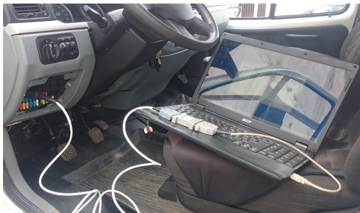
Р и с. 2. Программирование ЭБУ через разъем диагностики «EOBD II» F i g. 2. Programming the ECU via diagnostic connector EOBD II
