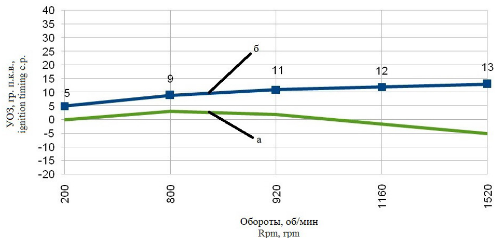
Р и с. 4. Угол опережения зажигания при пуске (а – УОЗ для базового ПО; б – УОЗ для модифицированного ПО)
