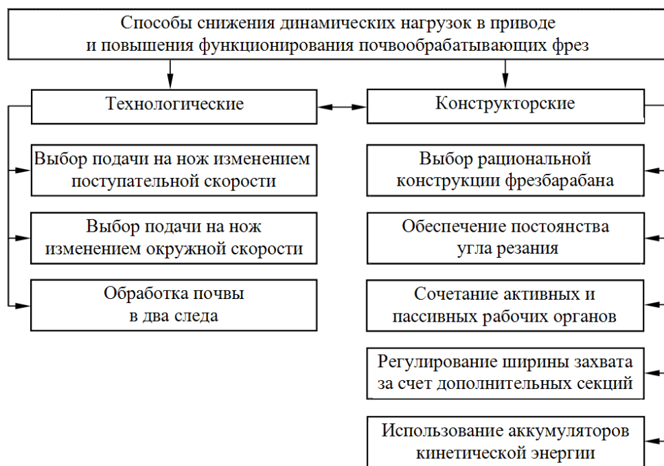
Рис. 1. Способы снижения динамических нагрузок в приводе и повышения функционирования почвообрабатывающих фрез
